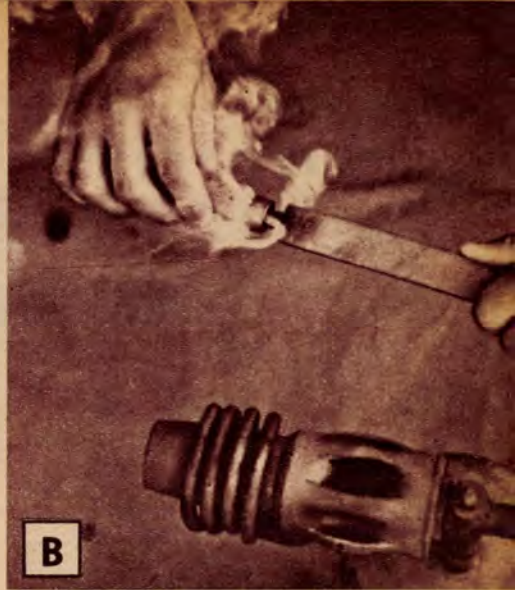
A reszelőnyél beégetése
